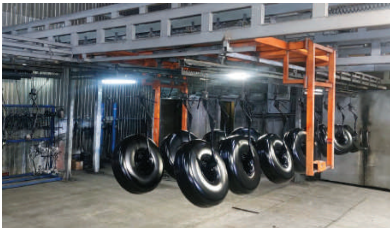
▲ Линия полимерной покраски тороидальных баллонов
