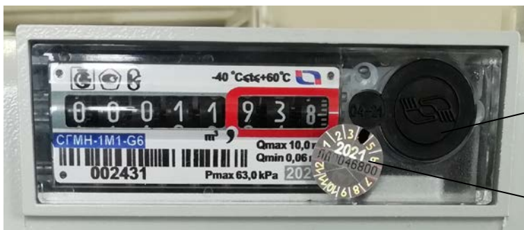
Рисунок 4– Расположение и внешний вид пломбы декадного счетчика и знака поверки БелГИМ
