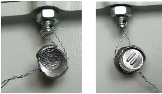
Рисунок 1–Расположение и внешний вид свинцовой пломбы
